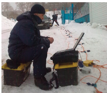
Рис. 4. Процесс выполнения полевых сейсморазведочных исследований
