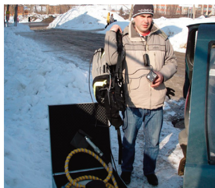
Рис. 5. Подготовка к выполнению полевых георадиолокационных исследований
